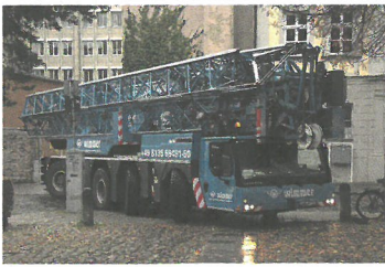
Der Mobilbaukran MK 88-4.1 kann mit HVO betrieben werden. Auf der Mawev zeigt er sich zusammen mit dem mobilen Energiespeichersystem Liduro Power Port im rein elektrischen Kranbetrieb
