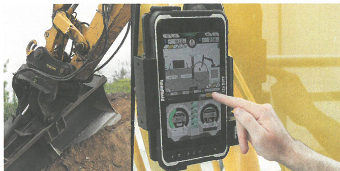
Das 3D Machine Guidance Kit bietet Kunden ein einfaches und übersichtliches 3D-Anzeigesystem mit dynamischer Nutzlastwaage
