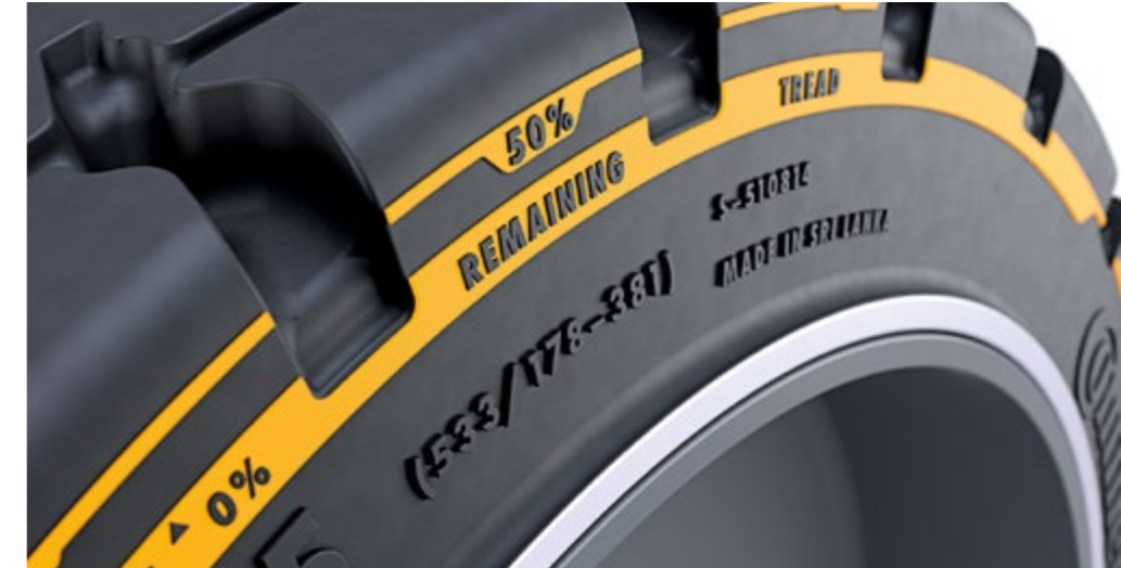
Reifenverschleißindikatoren geben Auskunft darüber, wann ein Reifen abgefahren ist.
