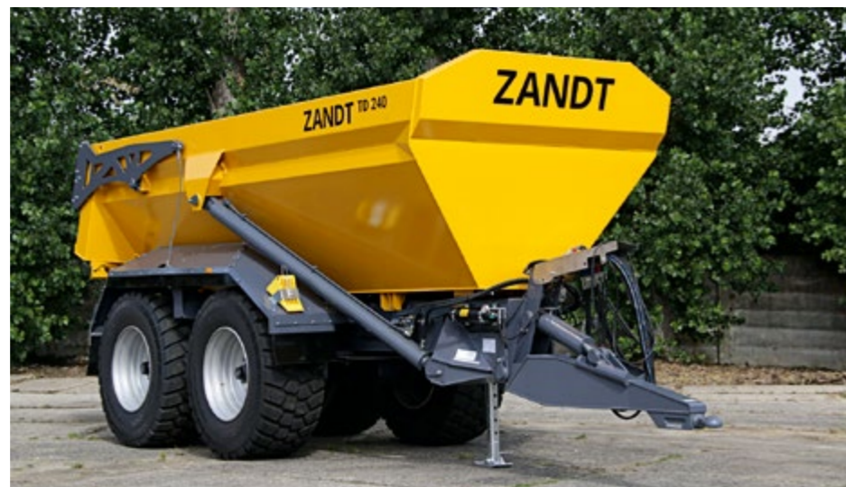
Der TD240 hat eine Nutzlast von maximal 32 Tonnen.
