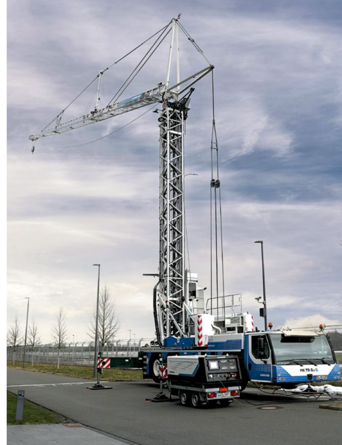
Der MK 88 4.1 kann mittels Liduro Power Port netzunabhängig betrieben werden.
