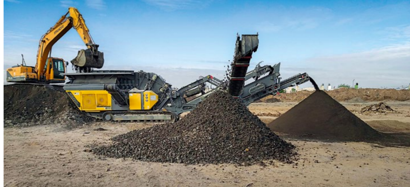
Der Rubblemaster 100GO! Zerkleinert Beton und Stahlschlacke von 0-500 mm auf 0-30 mm.
