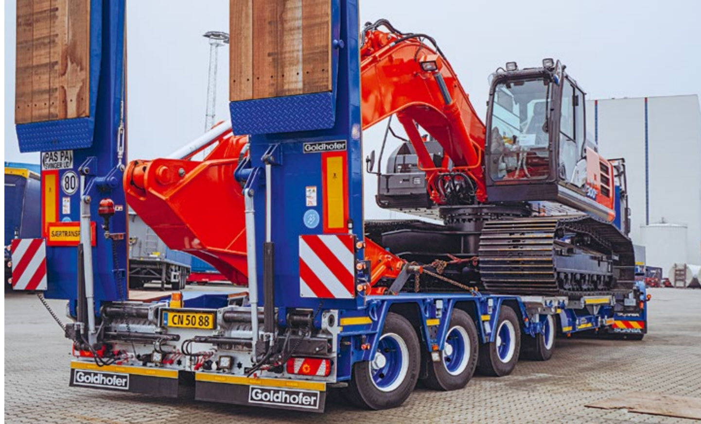
Der STZ-L4 kann bis zu 50 Tonnen transportieren.
