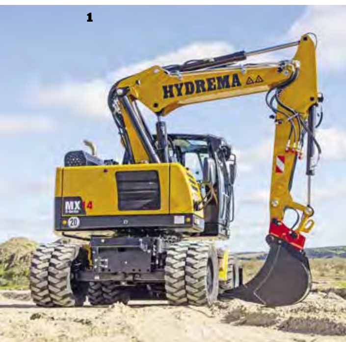
Die Bilder zeigen von Hydrema den kompakten MX14 G-Serie mit Stufe-5-Motor (1) und den neuen, vollelektrischen und knickgelenkten DT6 Muldenkipper (2); von Dieci einen Pegasus Teleskopklader mit 360°-Endlosdrehung (3); den Minelli Umschlagbagger M35 (4) und den kompakten Telekran 613 E von Sennebogen (5).
