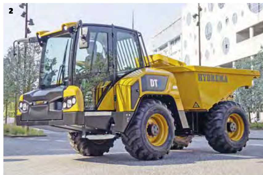
Die Bilder zeigen von Hydrema den kompakten MX14 G-Serie mit Stufe-5-Motor (1) und den neuen, vollelektrischen und knickgelenkten DT6 Muldenkipper (2); von Dieci einen Pegasus Teleskopklader mit 360°-Endlosdrehung (3); den Minelli Umschlagbagger M35 (4) und den kompakten Telekran 613 E von Sennebogen (5).
