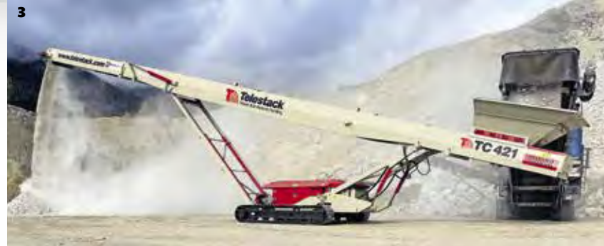
Zu sehen sein werden bei der Firma BAG Klösch unter anderem der kompakte Backenbrecher McCloskey J3CR (1), die Sandvik QE241 Grobstücksiebzanlage (2) und das raupenmobile Förderband Telestack TC421 (3).
