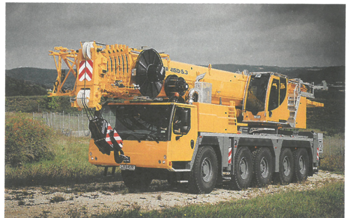
Der neue LTM 1150-5.3 bietet einen 66 Meter langen Teleskopausleger
