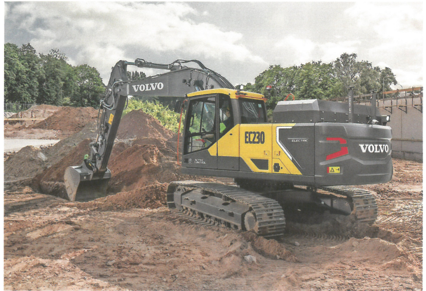
Der Volvo EC230 Electric feiert seine Österreichpremiere auf der Mawev Show. Dieser 23-Tonnen-Elektro-Kettenbagger bietet die gleiche Leistung wie ein vergleichbares Diesel-Modell, ist dabei allerdings emissionsfrei, geräusch- und vibrationsarm.
