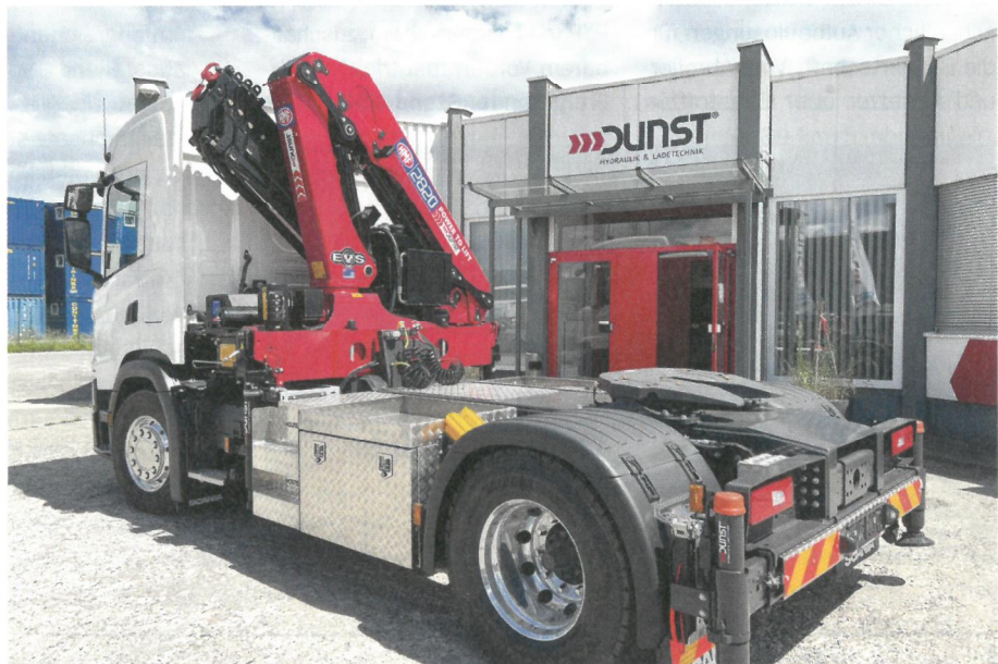
HMF 2820 Ladekran, ein allseitiger Kran mit großer Hubkapazität im Verhältnis zum herausragend niedrigen Eigengewicht
